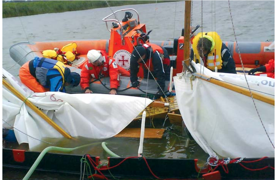
Das Seenotrettungsboot DORA liegt bei dem Segelkutter längsseits. Die Lenzpumpe der GERHARD TEN DOORNKAAT läuft: Es gelingt den Seenotrettern, den Kutter schwimmfähig zu halten.
