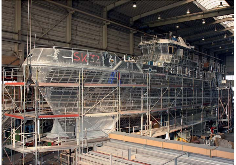
Der neue 36,5-Meter-Seenotkreuzer im Rohbau Anfang November auf der Fassmer-Werft
